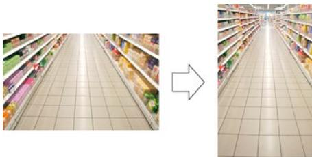
Sie können für die Überwachung von Gängen den Korridor-Modus verwenden. So wechseln wir vom 16:9 in das 9:16 Seitenverhältnis und konzentrieren uns effektiver auf das Wesentliche.
